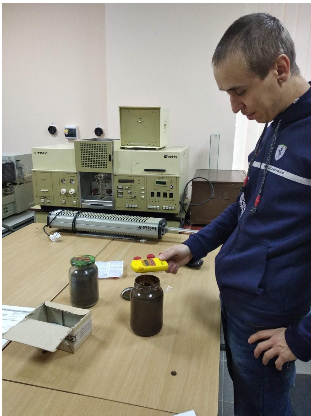
Рисунок Б.11 – Процес визначення радіоактивності зразків бурового шлангу
