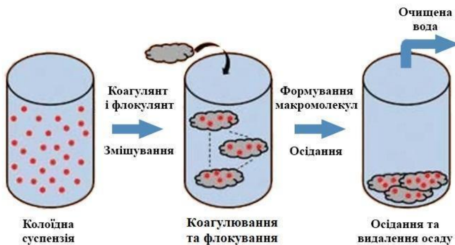
Рисунок 2.9 – Загальний механізм коагулювання з укрупненням частинок [83, 85]
