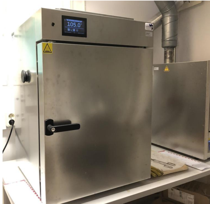
Рисунок 2.7 – Сушильна шафа з температурою 105 С для сушіння зразків БШ
