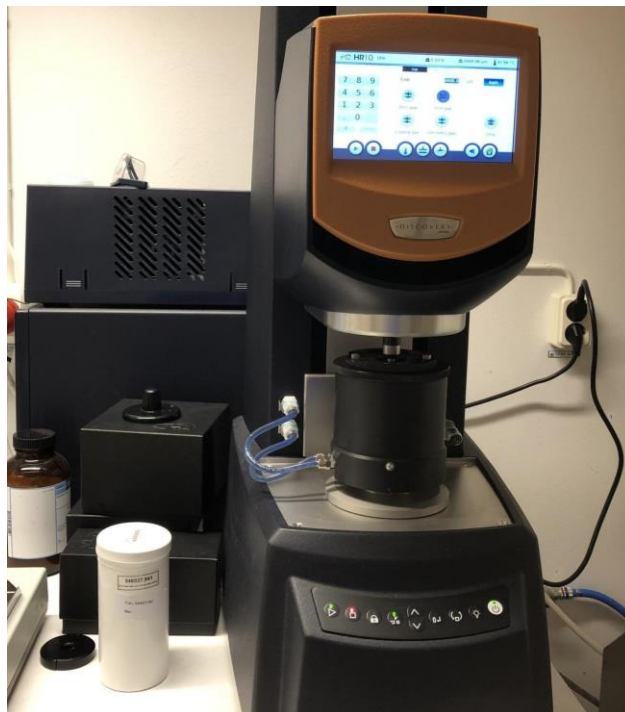
Рисунок 2.8 – Реометр Discovery Hybrid Rheometer HR 10 для визначення в'язкості бурового шламу
