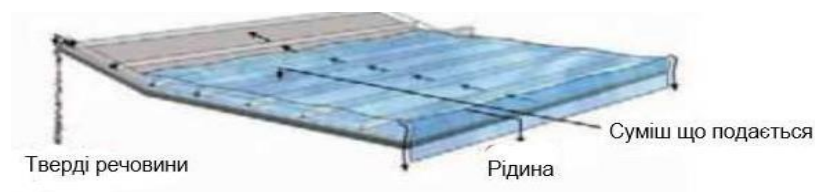
Рисунок 1.5 – Схема осадового резервуару з безперервним скребком
